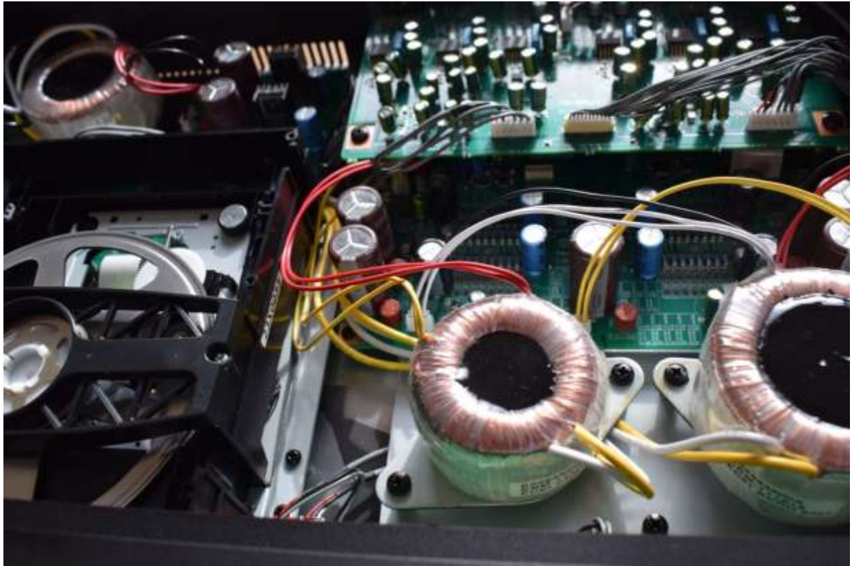
So etwas habe ich im Bauch eines CD-Player schon seit Jahren nicht mehr gesehen: Bauteile bis unters Dach und Trafos, die auch kleineren Verstärkern gut zu Gesicht stünden... Foto: H. Biermann)
